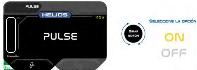
Cuando se selecciona la opción PULSE para el proceso de TIG. Aparece la onda de trabajo para la selección de pulso, en donde puede configurar el porcentaje de corriente pico (parte alta de la onda) y corriente base [parte baja de la onda], también es posible modificar la frecuencia de la onda de trabajo. Esta función permite una mejor transferencia de calor y eficiencia en el proceso de soldadura.
