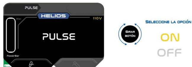
Cuando se selecciona la opción PULSE para el proceso de TIG. Aparece la onda de trabajo para la selección de pulso, en donde puede configurar el porcentaje de corriente pico (parte alta de la onda) y corriente base (parte
