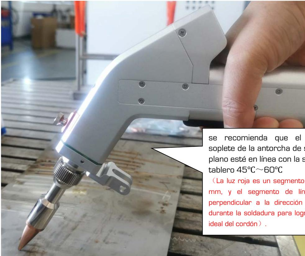
Los distintos ángulos entre el cabezal de la pistola y la pieza de trabajo suelen dar lugar a resultados de soldadura diferentes.
