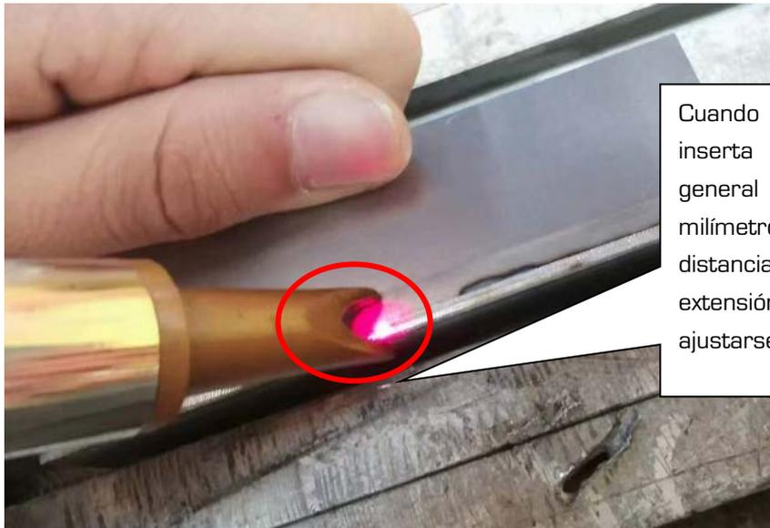
Cuando la pieza de trabajo se inserta en la boquilla, por lo general habrá unos pocos milímetros de desviación en la distancia focal, y la longitud de extensión de la boquilla debe ajustarse en consecuencia.
