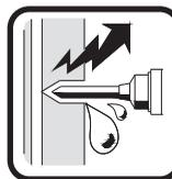
Tenga cuidado con los cables ocultos, la tubería de gas y la tubería de agua. Por favor, compruebe primero la zona de trabajo. Por ejemplo, utilice el detector mental.
